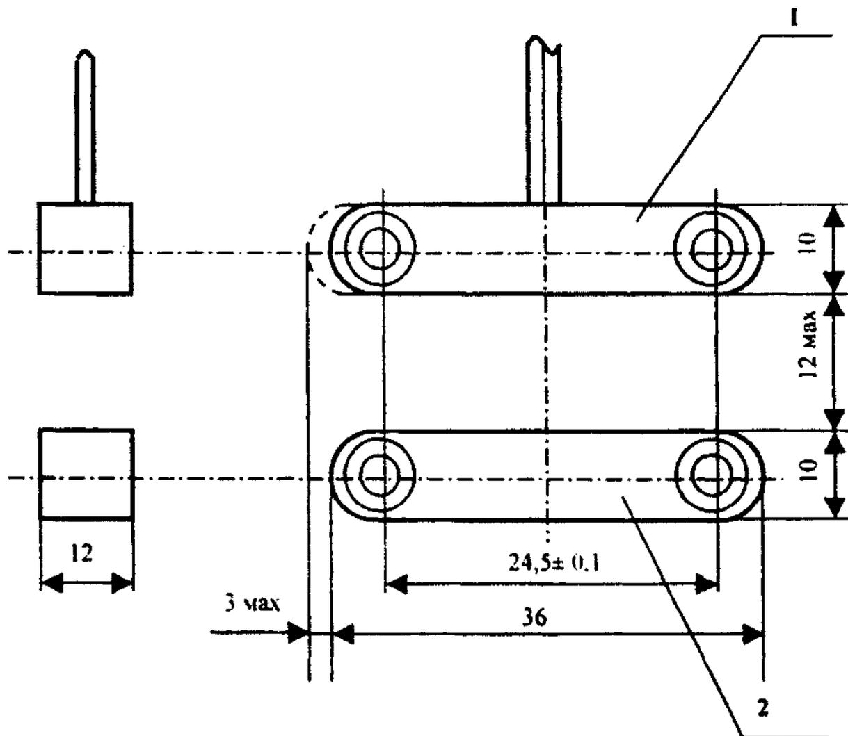
1 - датчик магнитоуправляемый
