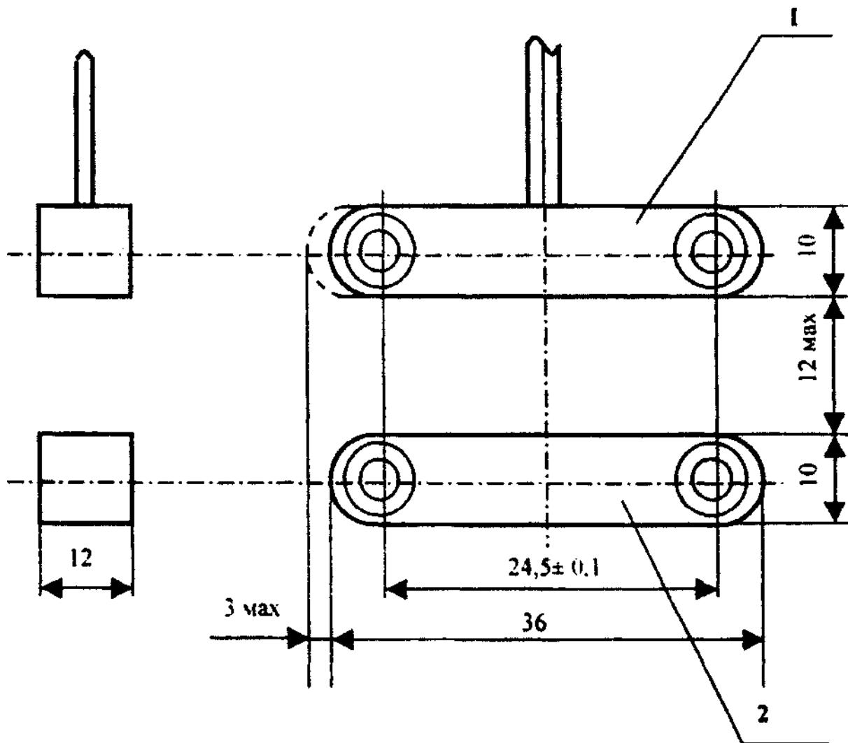
1 - датчик магнитоуправляемый
