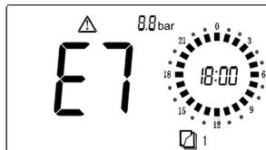
Датчик температуры теплоносителя неисправен.
